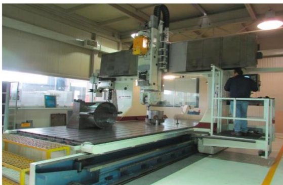
CENTRO DE MAQUINADO VERTICAL TIPO PUENTE DE 5 EJES, TOS KURI
