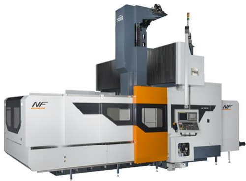
Máquina CNC de puente VISIONWIDE NF4223 Carrera x-4200 / y-2300 / z- 1020mm"
